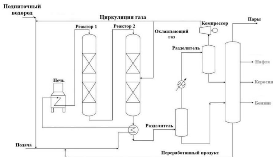
Рисунок 1.9 – Технологическая схема для процесса ГДС
